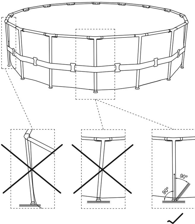
Después de completar la instalación de la estructura de acero de la piscina, compruebe que los elementos verticales se encuentren perpendiculares al suelo. De lo contrario, los elementos verticales pueden doblarse o deformarse.
