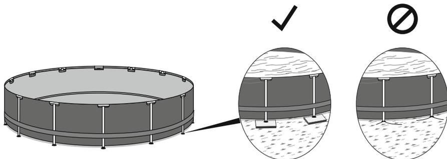
No monte las piscinas con patas sobre un terreno blando. Si debe montar la piscina sobre una superficie blanda, deberá colocar tableros de madera (no incluidos) debajo de las bases de los soportes verticales para distribuir bien el peso.
